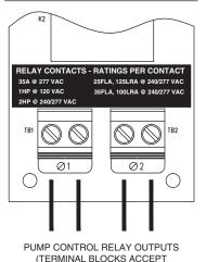
MAX. 8 AWG WIRES)
